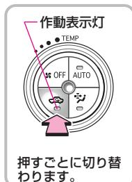
**内外気切り替えスイッチ**を押して外気導入と内気循環に切り替えます。
