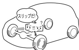
タイヤのスリップは4輪に取り付けられたセンサーからの信号を比較し、駆動輪のいずれかの信号が他の車輪より多い場合、スリップしているとコンピューターが判断します。それによって、スリップしているタイヤの駆動力を抑えるとブレーキをかけたり、エンジンの出力を一時的に抑えて、スリップを抑制させます。
