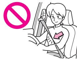
●ねじれていると、衝突したときなどに衝撃力を十分に分散させることができず危険です。
