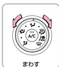
吹き出し口切り替えダイヤルをまわして吹き出し口を選択します。
