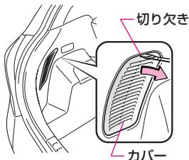
1 バックドアを開けて (P.134参照)、カバーを取りはずします。
