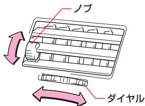
吹き出し口のノブを上下、またはダイヤルを左右に動かしてお好みの風向きに調整します。
