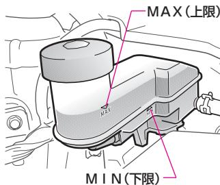
MAX(上限) ブレーキフルードの量がリザーバータンクのMAX(上限)とMIN(下限)のあいだにあるかを点検します。
