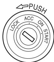
エンジンスイッチにキーを挿し込み、キーをまわして切り替えます。
