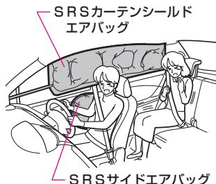
SRSサイドエアバッグは前席乗員、SRSカーテンシールドエアバッグは前後席乗員に、重大な危害がおよぶような強い衝撃を側方から車両客室部に受けたときに、衝撃を受けた側のSRSサイドエアバッグ、SRSカーテンシールドエアバッグがふくらみ、シートベルトが体を拘束する働きと併せて、SRSサイドエアバッグは前席乗員の胸などの上体に、SRSカーテンシールドエアバッグは前後席乗員の主に頭部に作用する衝撃を分散、緩和させる働きをするものです。
