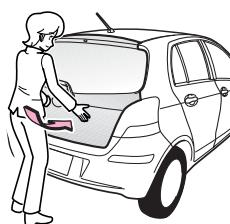
2 バックドアを外から押してロックします。
