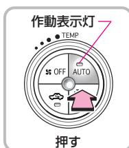
1 AUTOスイッチを押して吹き出し口と風量を自動調整にします。
