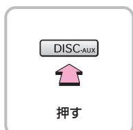
CDが挿入されている場合は、DISCスイッチを押すとCDが再生されます。
