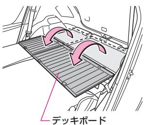
**6 デッキアンダートレイ装着車は、図のようにデッキボードを車両前方に展開させます。****もどすときは**
