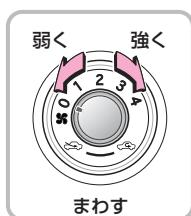
ファン調整ダイヤルをまわして風量を設定します。
