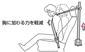
【衝突初期にシートベルトを瞬時に巻き取る】
