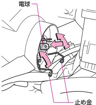
1 電球を取り付け、止め金をかけます。
