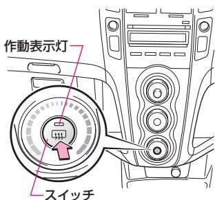
スイッチを押すと作動し、作動中にもう一度押すと停止します。
