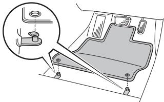
フロアマット付属の固定フック（クリップ）を使用して固定してください。詳しい固定方法はフロアマット付属の取扱書をお読みください。
