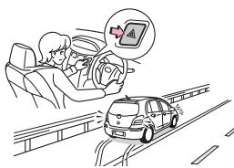
非常点滅灯（P.254の「非常点滅灯の使い方」参照）を点滅させながら、車を路肩に寄せ停車します。非常点滅灯は、故障などでやむを得ず路上駐車する場合、他車に知らせるため使用します。
