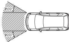
運転席・助手席SRSエアバッグは、車両前方左右約30°以内の方向から乗員に重大な傷害がおよぶような強い衝撃を受けたときに作動します。
