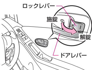
ロックレバーを前に押し込むと施錠、後方に引き出すと解錠されます。
