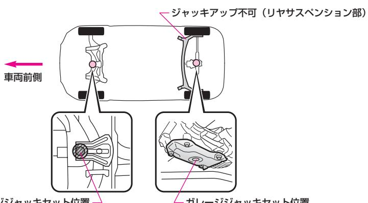
ガレージジャッキは、受皿の形状がガレージジャッキセット位置に適したサイズの受皿タイプを使用してください。
