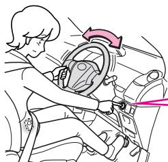
エンジン始動操作をしたときに、エンジンが始動せず“エンジンスタートストップ”スイッチの作動表示灯が緑色に点滅しているときは、ハンドルの負荷によりステアリングロックが解除されません。
