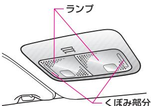
くぼみ部分を押すと押した側のフロントパーソナルランプが点灯し、もう一度押すと消灯します。
