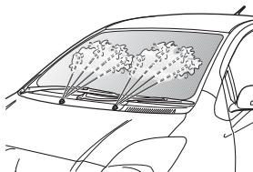
エンジンを始動し、ウィンドウウォッシャーを作動させ、噴射の向きおよび高さがワイパーの作動範囲のほぼ中央にあたるかを点検します。
