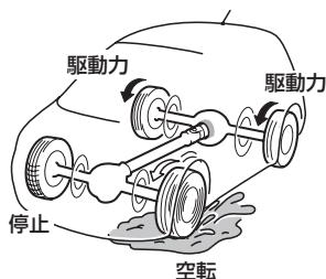
コーナリング時や雪道など前・後輪間に回転差が発生すると、ビスカスカップリングが作動し、後輪に駆動力が伝達され、4WD状態になります。
