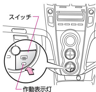
スイッチを押すと約15分間作動し、作動中にもう一度押すと停止します。
