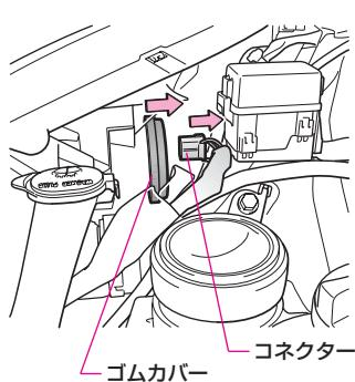
1 ボンネットを開けて (P.147参照)、コネクターとゴムカバーを取りはずします。
