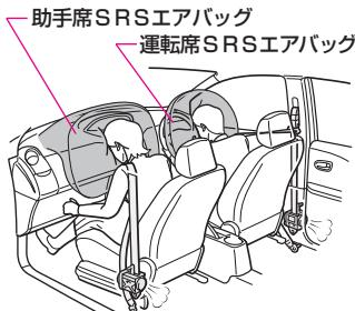
運転席・助手席SRSエアバッグは、運転者または助手席乗員に重大な危害がおよぶような強い衝撃を車両前方から受けたときにふくらみ、シートベルトが体を拘束する働きと併せて、乗員の頭や胸などに作用する衝撃を分散、緩和させる働きをするものです。
