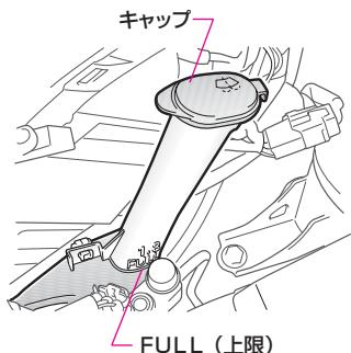
ウォッシャータンク側面から、液面を確認します。ウォッシャー液が不足しているときは、ウォッシャー液を補給してください。
