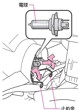
2 止め金をはずし、電球を取りはずします。
