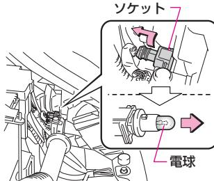
ボンネットを開けて（P.147参照）、ソケットと電球を取りはずします。
