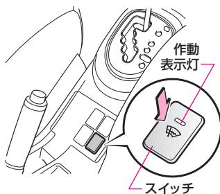
スイッチを押すと約15分間作動し、作動中にもう一度押すと停止します。
