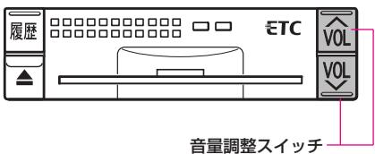
ETCユニットの音量調整スイッチで、ETCユニットから出力される音声案内の音量を8段階に調整することができます。
