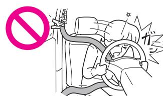
■プレートをバックルに挿し込むときは、プレートとバックルが“カチッ”と音がして確実にかみ合っていることを確認してください。
