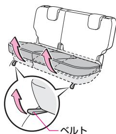
3 シートクッション前端のベルトを引き上げて、クッション前部を持ち上げます。
