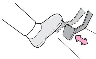
エンジンを始動し、ブレーキペダルをいっぱいに踏み込み、床板とのすき間（P.421参照）を点検します。併せてペダルの感触に異常がないかを点検します。
