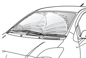
エンジンを始動し、ウィンドウウォッシャーでガラスをぬらした状態でワイパーを作動させ、「間欠作動」「低速作動」「高速作動」「一時作動」の各作動が良いか、拭き取り状態が良いか点検します。
