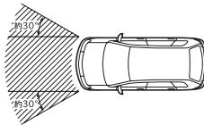
車両前方左右約30°以内の方向から乗員に重大な危害がおよぶような強い衝撃を受けたときに作動します。
