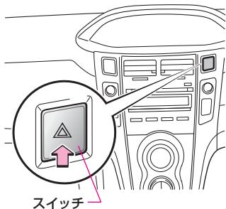
スイッチを押すと、すべての方向指示灯が点滅し、もう一度押すと消灯します。
