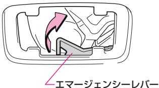
3 エマージェンシーレバーを矢印の方向に操作してバックドアを開けます。
