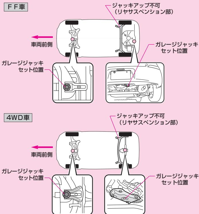
ガレージジャッキは、受皿の形状がガレージジャッキセット位置に適したサイズの受皿タイプを使用してください。
