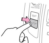
A U T O · Pスイッチを“ピッ”と音がするまで押し続けると、自動でプリセットスイッチに放送局がセットできます。
