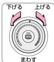
温度調整ダイヤルをまわして温度を設定します。
