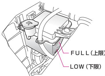
冷却水の量がリザーバータンクのFULL（上限）とLOW（下限）のあいだにあるかを点検します。
