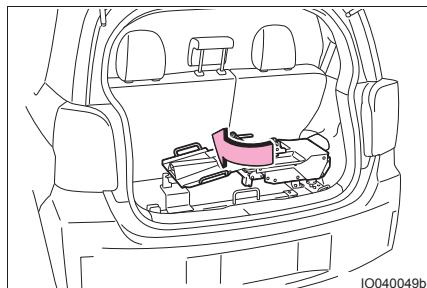
**4 操作スイッチの「下」を押し続け、車いす収納装置をいちばん左までスライドさせる**
