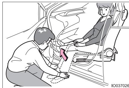
7 助手席回転チルトシートを車内に回転させ、格納する
