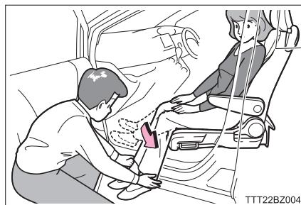
6 助手席回転チルトシートを回転完了位置まで回転させる
