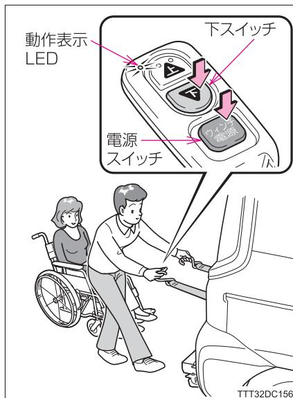
⑩ ベルトがねじれないように最後まで手を添えて巻き取る
