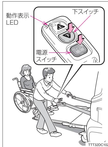
**10** ベルトがねじれないように最後まで手を添えて巻き取る
