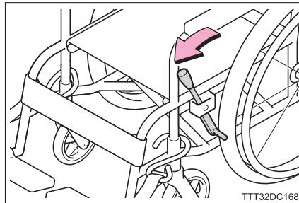
8 車いす固定装置のフックを床面の固定部から取りはずして引き出し、フックを車いすの後部フレームに引っかける
