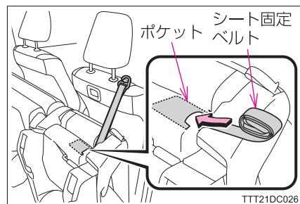
バックルを引き上げ、ベルトをゆるめる
