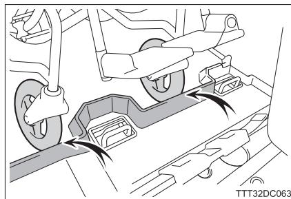
**4** 車いすのブレーキを両輪ともかける**5** 車いす固定装置のフックを床面の固定部から取りはずして引き出し、フックを車いすの後部フレームに引っかける
