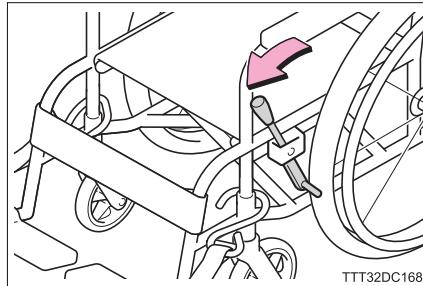
9 車いす固定装置のフックを床面の固定部から取りはずして引き出し、フックを車いすの後部フレームに引っかける
