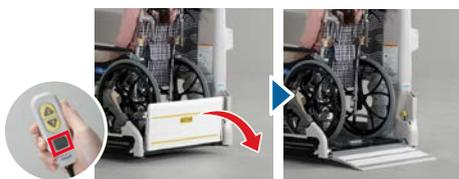
操作スイッチの倒しボタンを押し続け、
