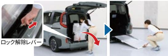
スロープを支えながらロック解除レバーを引き、スロープを車外へ最後まで引き出す
