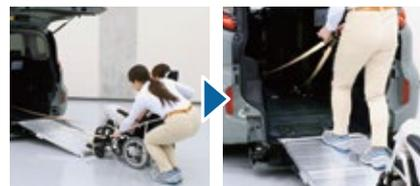
車いすのブレーキをかけ、セーフティベルトのフックをはずし、車内へ巻き取る
