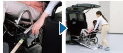
車いすのブレーキを解除し、車いすを少し前に押ししてから、後退し車外に出す
