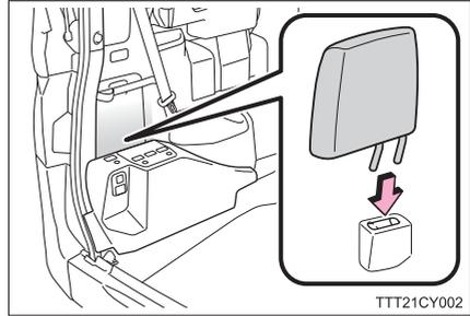
停止表示板搭載時には、停止表示板とカバーの間にヘッドレストを格納してください。
