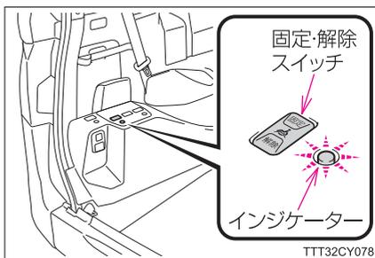
固定・解除スイッチのインジケータが点滅していないときは、固定・解除スイッチの「解除」を押し、点滅していることを確認する
