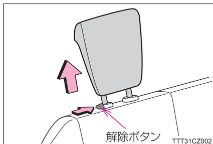
③ 車いす固定ベルト A を サードシート左右席のヘッドレスト部に取り付ける
