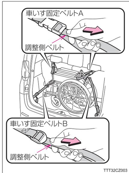
**収納・固定のしかた（固定方法 B）****1** 車いすを折りたたみ、後輪のブレーキを両輪ともかける
