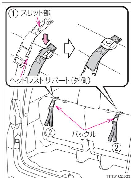
④ サードシート左右席にヘッドレストを取り付け、乗員がいないときはヘッドレストを下げる
