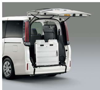
②バックドアを開け、車高調整スイッチの「下」を押します。(下がりとすると自動停止します)
