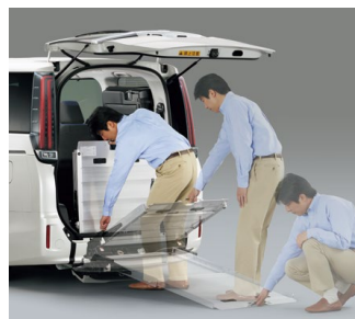
③スロープが前倒れ状態になっている場合は垂直に起こします。スロープを支えながら、ロック解除レバーを引き上げてロックを解除し、スロープの取っ手を持って車外へ引き出します。 ※スロープは二重になって格納されています。
