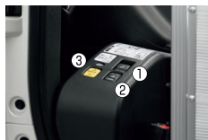
※写真はタイプII ①セーフティベルトスイッチ(サード席用) ②固定装置スイッチ(サード席用) ③車高調整スイッチ
