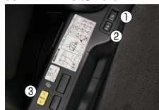
※写真はタイプI「車いす」脚仕様。 ①セーフティベルトスイッチ(セカンド席用) ②固定装置スイッチ(セカンド席用) ③車高調整スイッチ
