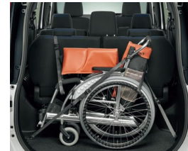
手動車いす用固定装置 (助手席リフトアップシート付車のみ)
