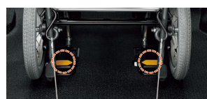
車いす固定マーク
