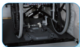
車いす固定装置 (ワンタッチ式/電動) 車椅子簡易固定標準化 コンソーシアムのガイドライン 準拠品
