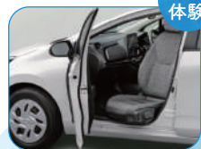
いつでもウェルキャブ (ターンチルトシート/車いす収納装置)
