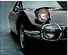
ヘッドランプは引き出し式で、プロトタイプ・レーサーの設計。ワイパーも流して落ちるがらないスクリーン構造。4輪ディスクブレーキや、ラックがエンジン式スタビライザーなど、すべてハイ・スピード走行に特化した設計が実現しています。
