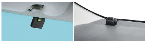
ETCアンテナ装着例
