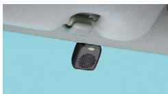
ETCアンテナ装着例
