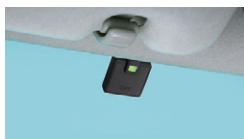
ETCアンテナ装着例
