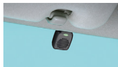
ETCアンテナ装着例
