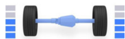
ディスプレイオーディオ内の前後輪トルク配分量表示
