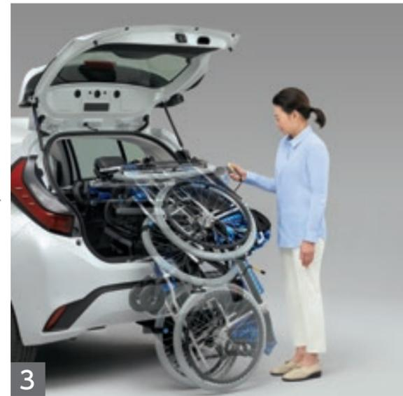
3 操作スイッチの「上」を押し続け、車いすと収納装置を車内に収納します。
