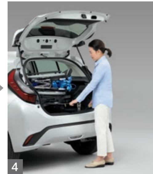
4 収納装置の操作ハンドルを持ち、止まるまで車内に回転させます。
