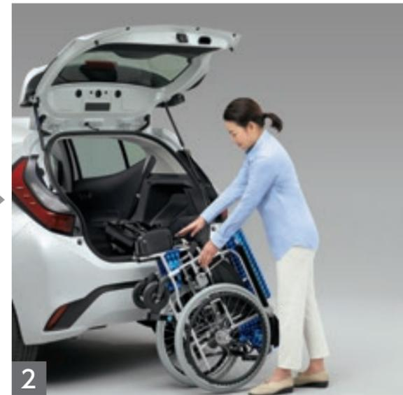
2 上下のアームに車いすをセットし、吊り上げアームの先端にある車いす開き防止バーで車いすを固定します。その後、車いすのブレーキを掛けます。
