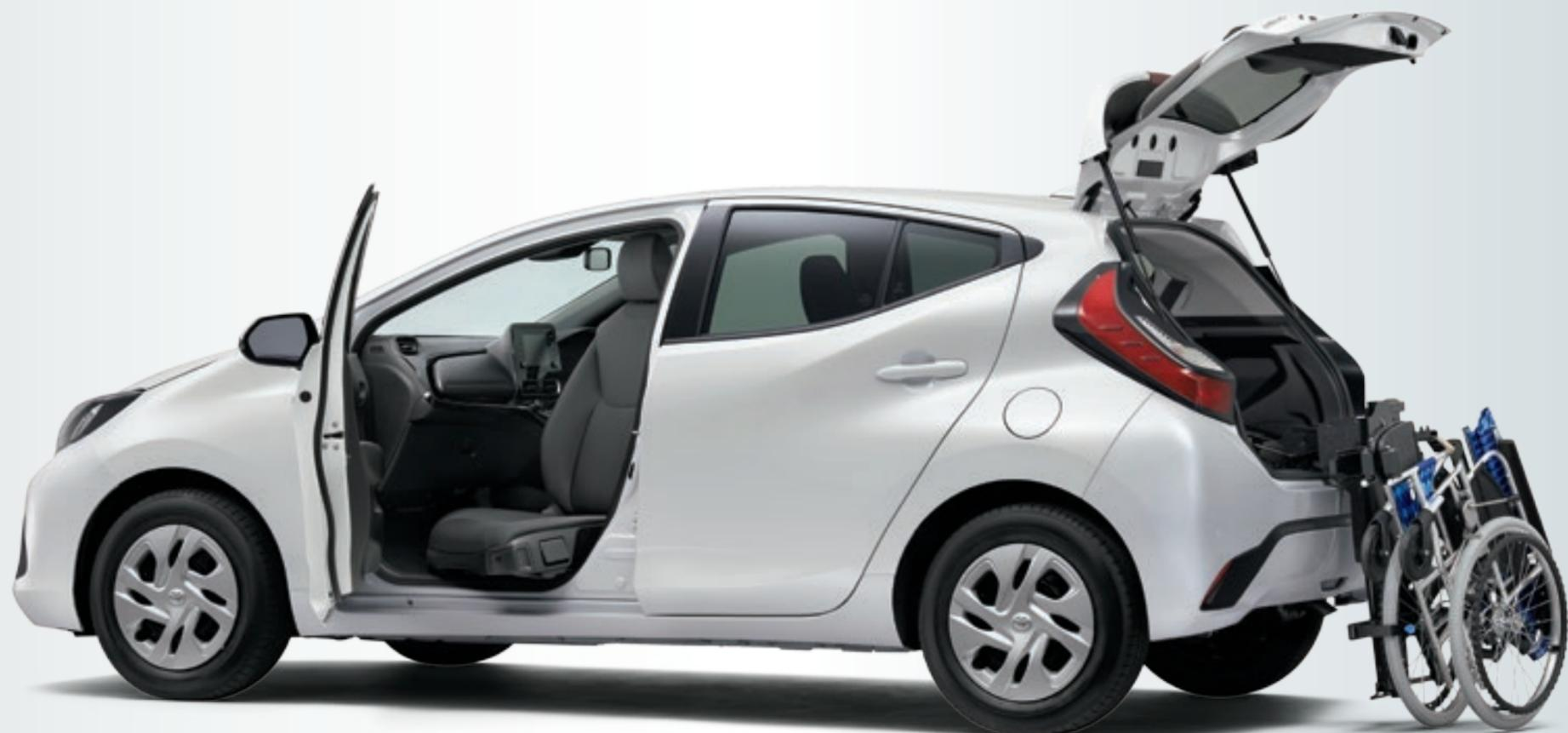
助手席が回転&チルトするターンチルトシートと、35kgまでの車いすをスムーズに収納できる電動式の車いす収納装置を標準装備。
