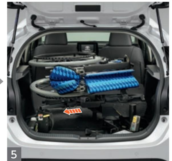
5 操作スイッチの「下」を押し続け、車いすと収納装置をストッパーに当たるまでスライドし、固定ベルトで固定します。
