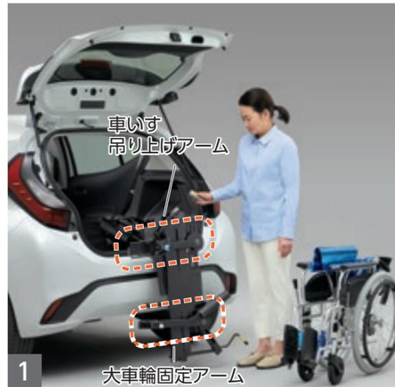
1 操作スイッチを使って収納装置を車外に出します。上下のアームが展開されていることを確認してください。
