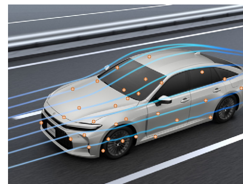
機能あり状態のイメージ: 走行によるタイヤ周りの帯電を低減することで、タイヤ周りの流れの乱れを低減
