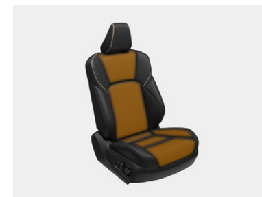
オレンジは、ヒーター加温箇所
