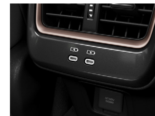
㉟充電用USB端子 (Type-C/センターコンソール後部2個・LED照明付)
