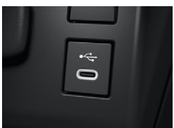
⑬通信/充電用USB端子 (Type-C/センターコンソールボックス内側1個)
