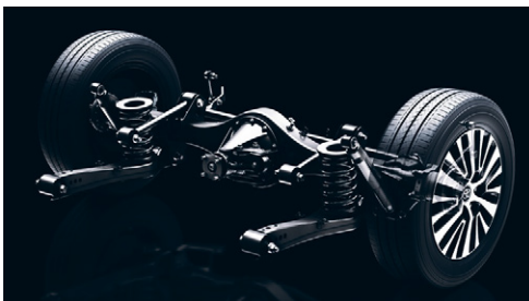
トレーリングリンク車軸式リヤサスペンション ■写真はイメージです。
