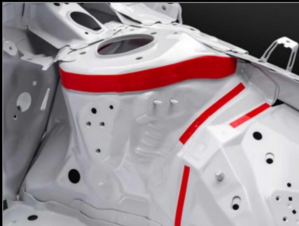
フロントサスタワースポット溶接
