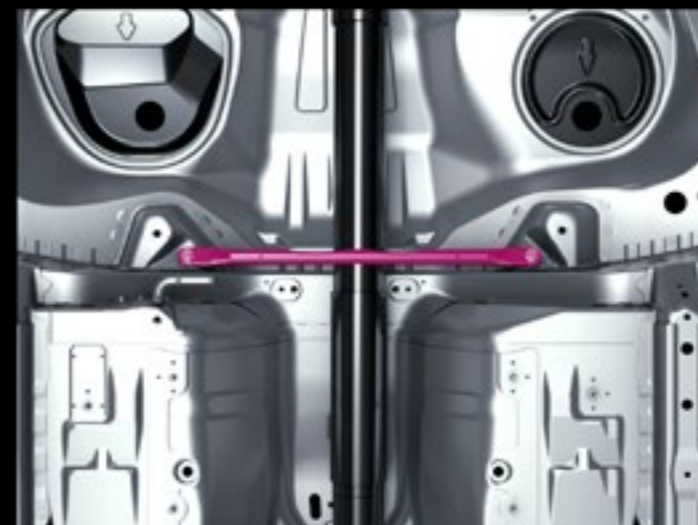
タンク前床下ブレース
