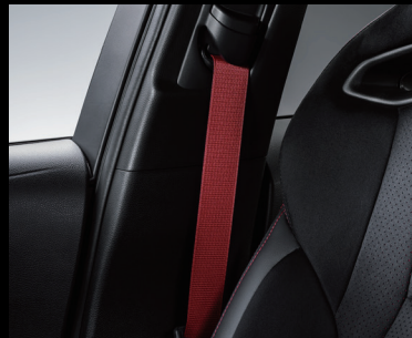
▶ ELR付3点式レッドシートベルト(プリテンショナー&フォースリミッター機構付[フロント])
