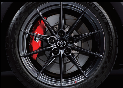
▶ 245/40ZR18タイヤ(MICHELIN PILOT SPORT CUP 2 CONNECT)×TOYOTA GAZOO Racing ロゴ付BBS製鍛造アルミホイール(専用マット塗装/センターオーナメント付)+黒色ホイールナット*1
