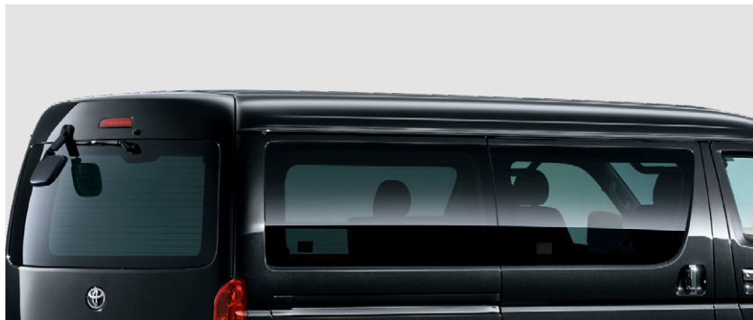
IR(赤外線)カットフィルム取付位置
