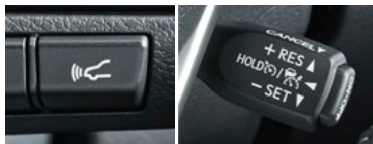
車間距離切替スイッチ/レーダークルーズコントロールスイッチ
