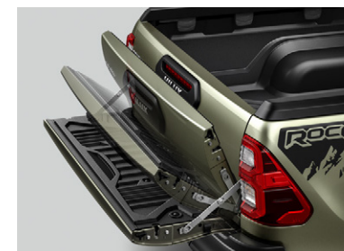
▶テールゲートリフトアシスト 重たいテールゲートの開閉をサポート。 楽に開閉することができます。
