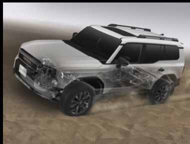
クローラコントロールシステム作動イメージ(スタック状態からの後退脱出)
