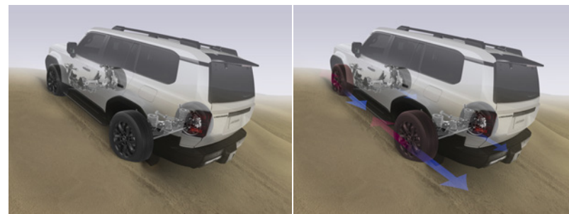
クローラコントロールシステム作動イメージ(スタック状態からの後退脱出)
