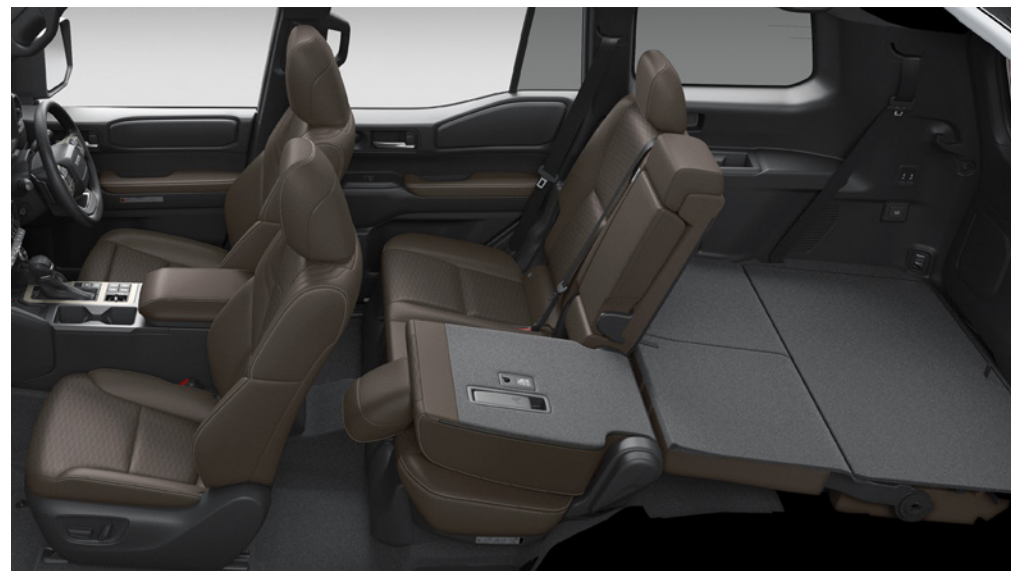
セカンドシート片側前倒し+サードシート両側フロア格納状態
