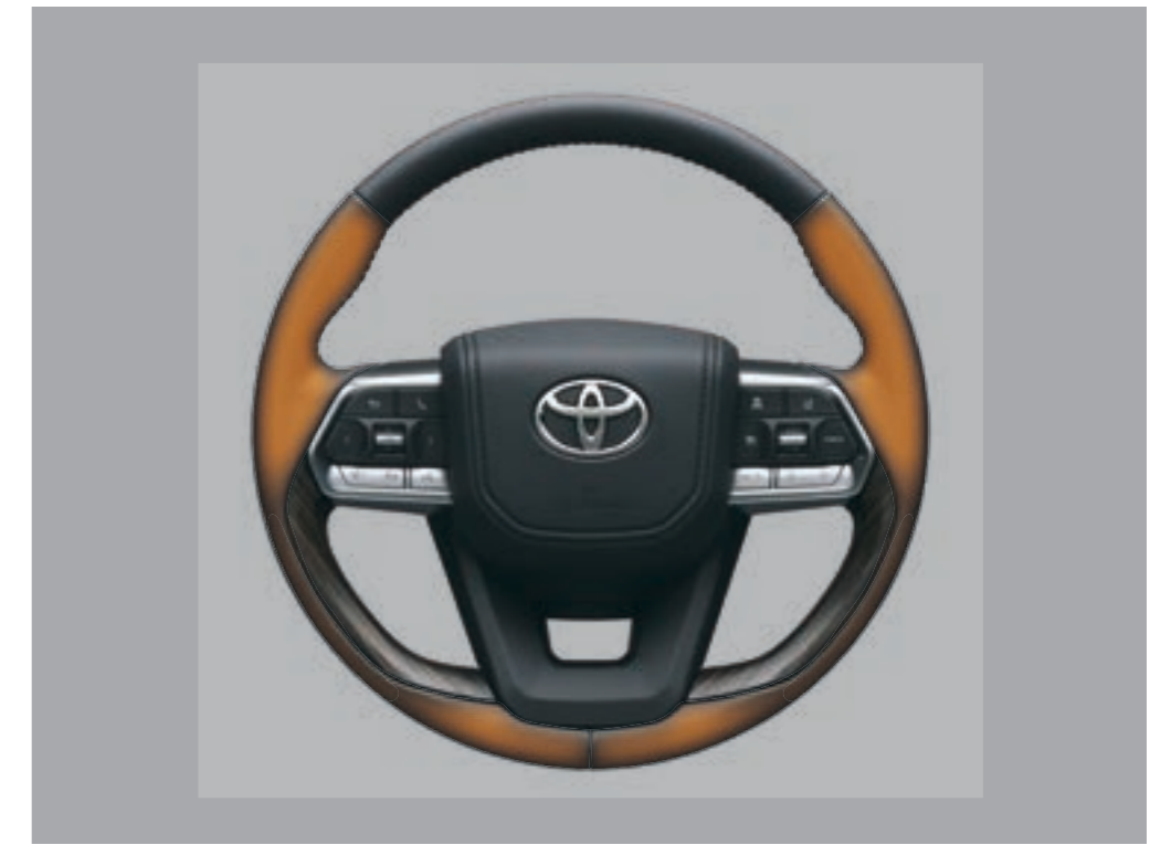
ヒーター加温箇所
