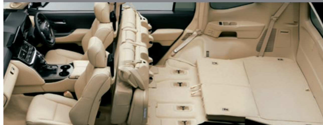
セカンドシートタンブル+サードシート両側フロア格納状態
