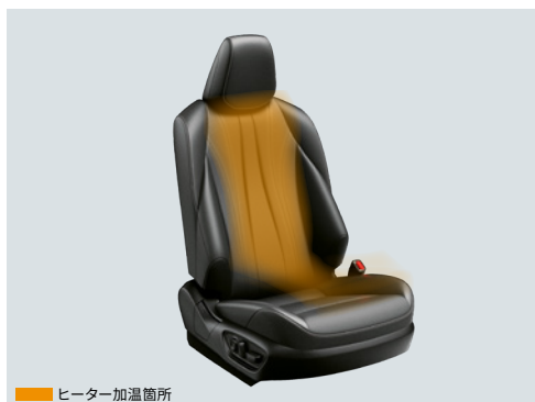
ヒーター加熱箇所
