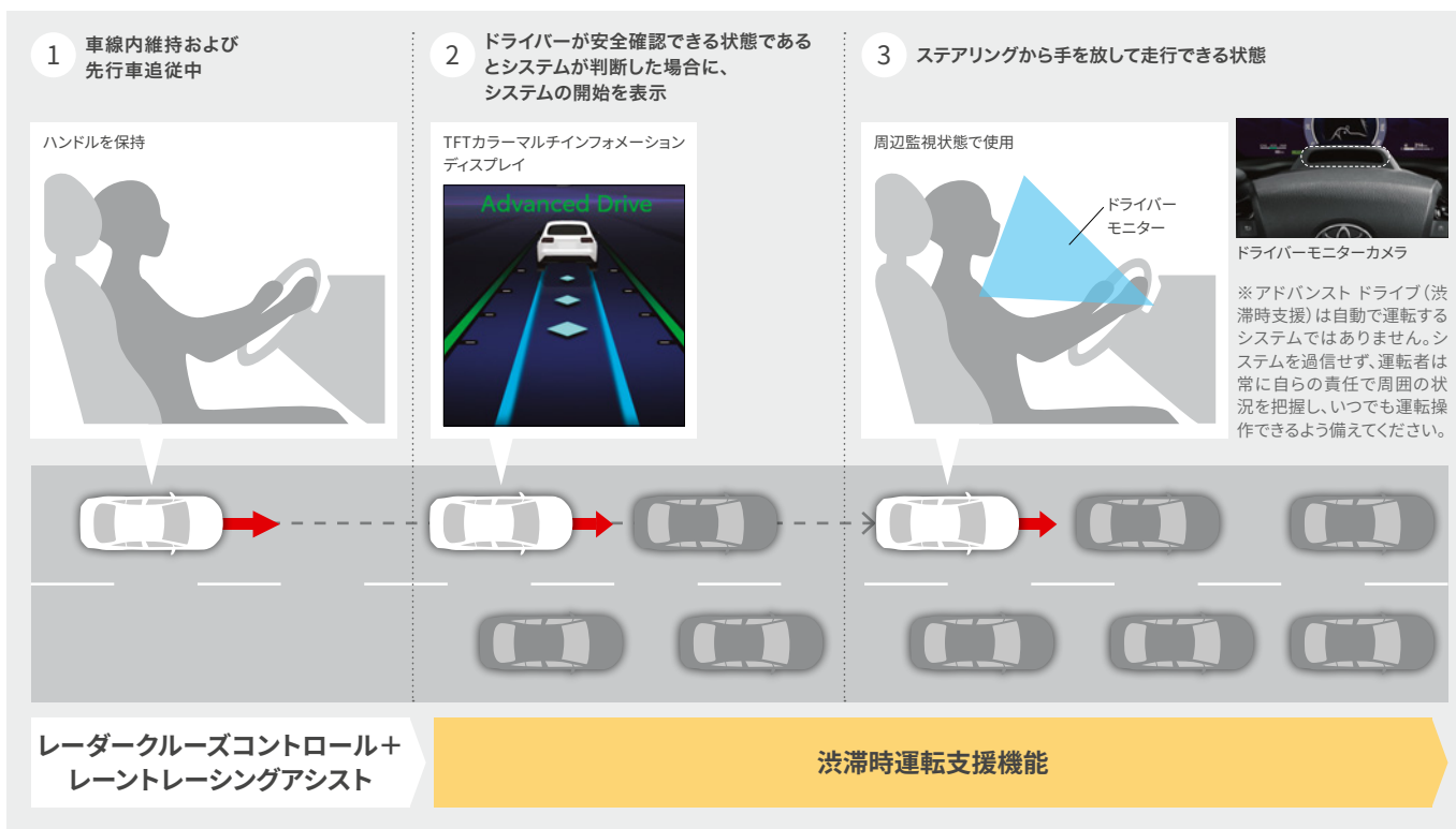
■ドライバーモニターカメラで運転者が周囲の状況を確認し、運転操作できる状態であるかシステムが判断します。システムが運転操作ができない状態と判断した場合は、ブザーとディスプレイ表示で注意喚起を行います*2。
