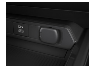
Ⓜアクセサリソケット (DC12V・120W/センターコンソール前部1個)
