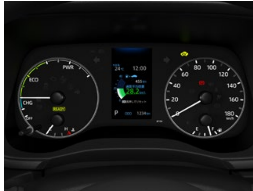
アナログメーター+4.2インチTFTカラーマルチインフォメーションディスプレイ ■写真はハイブリッド車。
