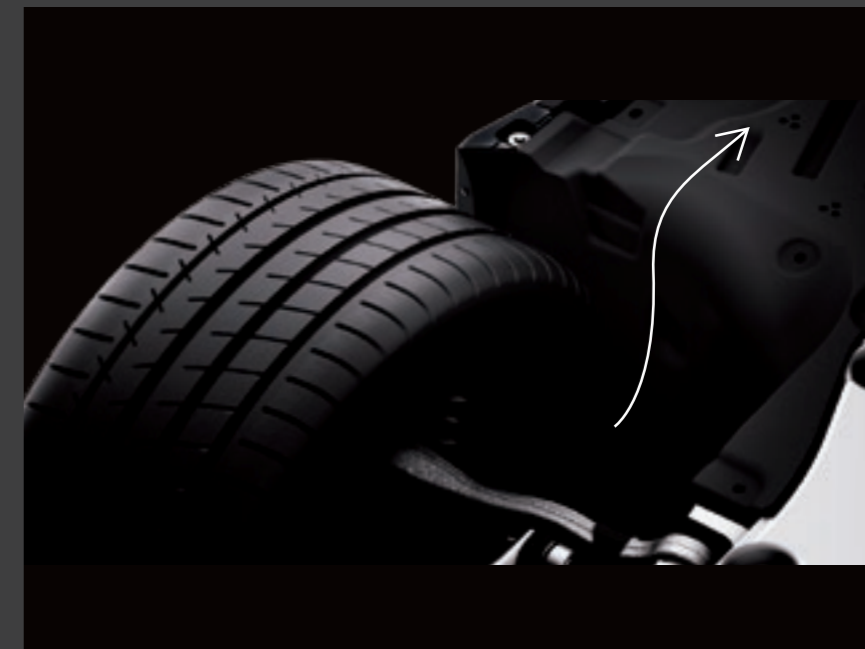
B | ホイールアーチからアンダーフロアへの一体形状
