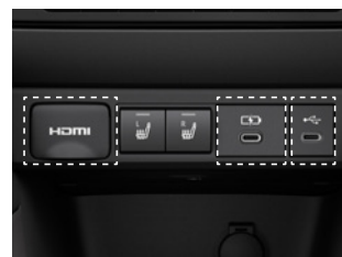
㊿HDMI入力端子 ㊿充電用USB端子 (Type-C) ㊿USB入力 (動画・音楽再生/給電 [Type-C]) [㊿・㊿はZ、G、Uに標準装備。Xにメーカーオプション]
